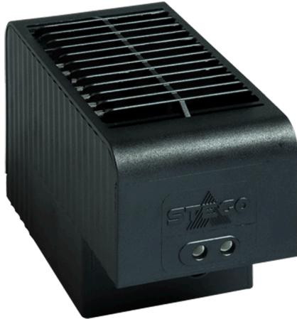
Il Miniriscaldatore anticondensa a semiconduttore compatto con ventilatore ed elemento termico aiuta a prevenire la formazione di brina e condensa negli alloggiamenti e negli spazi di installazione. Il rivestimento in plastica rende il Riscaldatore sicuro al tatto durante l'applicazione. Connessione elettrica rapida tramite Spina di alimentazione IEC.
