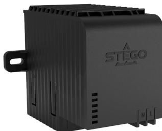
CS 032 Miniriscaldatore anticondensa a semiconduttore: compatto e dotato di ventilatore e di elemento termico a ventola, offre una protezione affidabile contro il gelo e la condensa. La guaina in plastica a prova di contatto garantisce condizioni di lavoro sicure, mentre i morsetti a pressione rendono il contatto elettrico rapido e stabile. Con potenze termiche di 600, 800 e 1.000 W, il Riscaldatore può essere utilizzato per un'ampia gamma di applicazioni.
