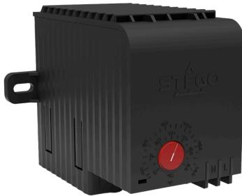
CS 032 Plus - Miniriscaldatore di riscaldamento con ventola ed elemento termico a semiconduttore, che si adatta in modo affidabile al gelo e alla condensazione. Il Riscaldatore ventilato CS 032 Plus è dotato di una manopola di selezione della temperatura di facile utilizzo. La potenza termica variabile è possibile grazie a un comportamento di controllo intelligente. L'opzione di installazione flessibile (variabile) favorisce una Circolazione dell'aria ottimale.
