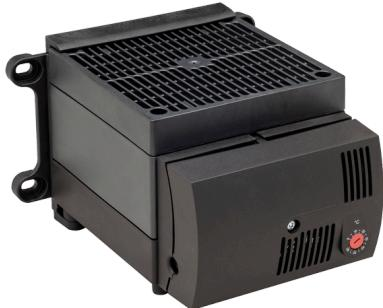
Il ventilatore di riscaldamento compatto ad alte prestazioni è progettato per il controllo uniforme della temperatura di alloggiamenti e quadri elettrici, per Contattore contro la condensa dannosa. Sono disponibili versioni con termostato integrato. Tecnologia di riscaldamento: PTC per un comportamento dinamico di risposta. A prova di applicazione grazie all'involucro in plastica touch-safe.
